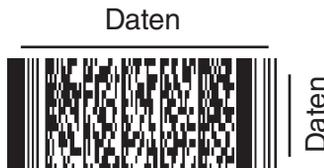
**3. Composite Symbologies** bestehen aus mehreren Komponenten, wobei der lineare Anteil gleichzeitig als Orientierungssymbol dient (z. B. EAN, Code 128 oder 2/5 Interleaved). Ergänzt wird das Symbol durch eine 2D-Komponente. Hintergrund der Entwicklung ist der Wunsch, bei Beibehaltung der linearen Symbologie (Artikelnummer) zusätzlich Angaben über Lagerort, Mindesthaltbarkeit, Chargennummer und andere Informationen zu verschlüsseln.
