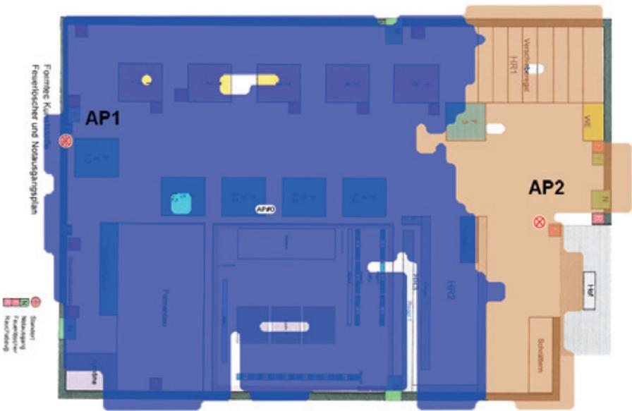
Die Funkvermessungskarte zeigt die Funkabdeckung des AP1 und AP2. Hierbei ist zu sehen, dass die komplette Produktionshalle durch die beiden Accesspoints mit Richtantennen (AP1 und AP2) ausgeleuchtet werden konnte.
