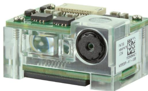
*Dank der kompakten Abmessungen und dem integrierten Decoder, lässt sich die Leistung des 2D-Imagers der Reihe N3680 nahtlos in Ihre Geräte integrieren.*
